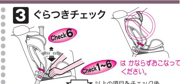
● ぐらつきチェックで、腰ベルト付近のベース部を前後左右にゆすり、約3cm以上ぐらつく場合はもう一度取り付け手順の1~2の順序で、取り付けをやり直してください。(4. 取り付け可能な車両シートベルト参照)
