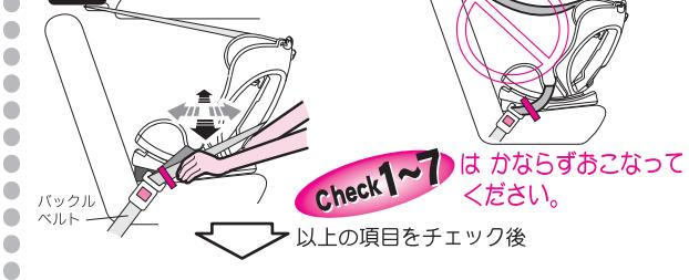
● ぐらつきチェックで、腰ベルト付近のベース部を前後左右にゆすり、約3cm以上ぐらつく場合はもう一度取り付け手順の1~2の順序で、取り付けをやり直してください。(4. 取り付け可能な車両シートベルト参照)
