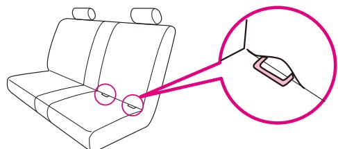
本装置は、認可された車両がUN/ECE 規則No. 16または同等の基準で認可された3 点式リトラクター付き安全ベルトとISOFIX取付け金具を装備している場合のみに適しています。
